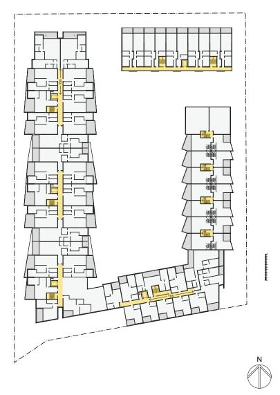
FIGURE 9. COMMON CIRCULATION SPACES AT TYPICAL FLOOR
